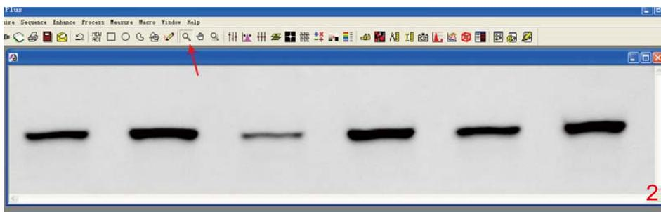
(2) Measure-Calibration-Intensity-Options-Image, 在图片上的空白区域内点击, 选择背景最大 value 值以校正背景, 然后选OK-OK-System-Closed.
